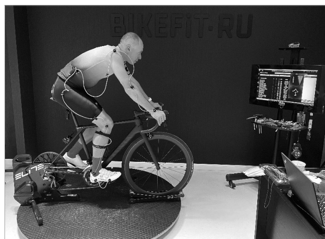
Рис. 3. Процедура видеоанализа с использованием технологии захвата движения
